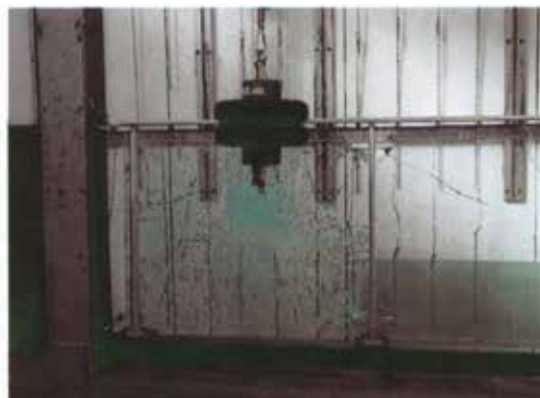
Fotografia del campione dopo urto al centro del corrimano fra due montanti Picture of the sample after the impact at the center of the handrail between the two uprights
