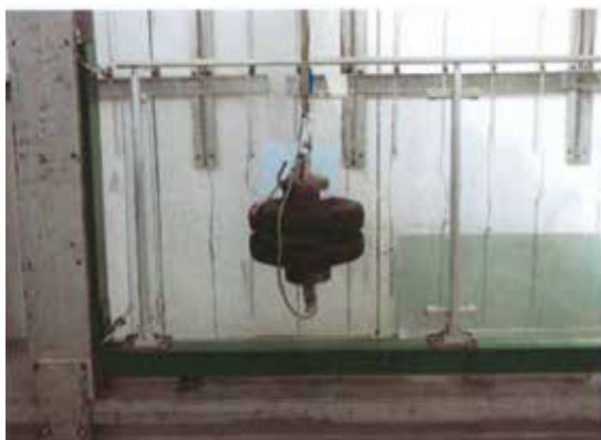
Fotografia del campione dopo urto al centro del tamponamento Picture of the sample after the impact at the center of the collision
