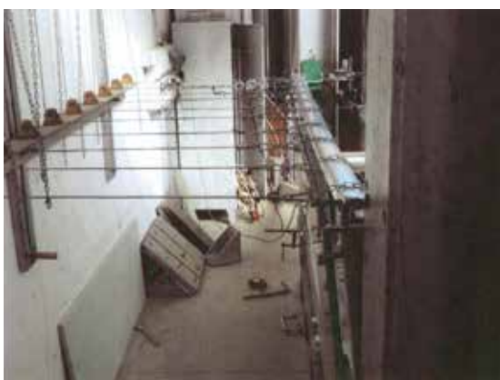
Fotografia del campione sottoposto a carico statico lineare orizzontale Picture of the sample subjected to horizontal linear static load
