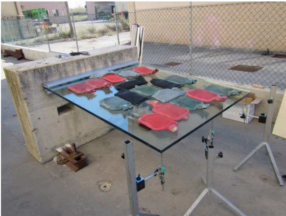
Fotografie della disposizione del carico sull'oggetto durante i vari step
