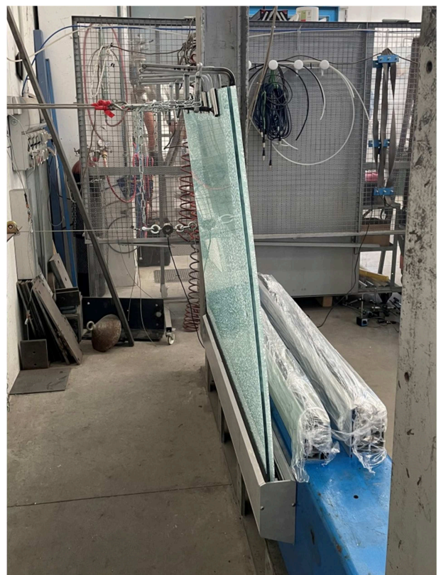
Fotografia dell'oggetto durante l'applicazione del carico di collasso
