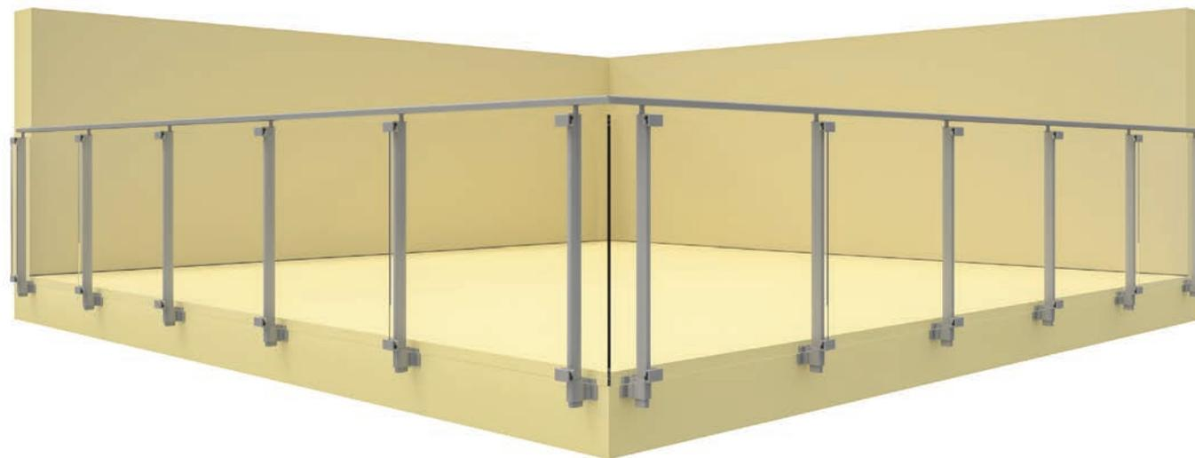
Il modello Strong monta speciali supporti per vetri temperati di spessore 8+1.52pvb+8: trattandosi di un vetro dalle elevate prestazioni in termini di resistenza agli urti, il modello è certificato senza l'utilizzo di alcuna canalina a contorno del vetro. I supporti sono regolabili in altezza in qualsiasi momento e vengono bloccati mediante appositi grani in acciaio inossidabile forniti con il sistema.
