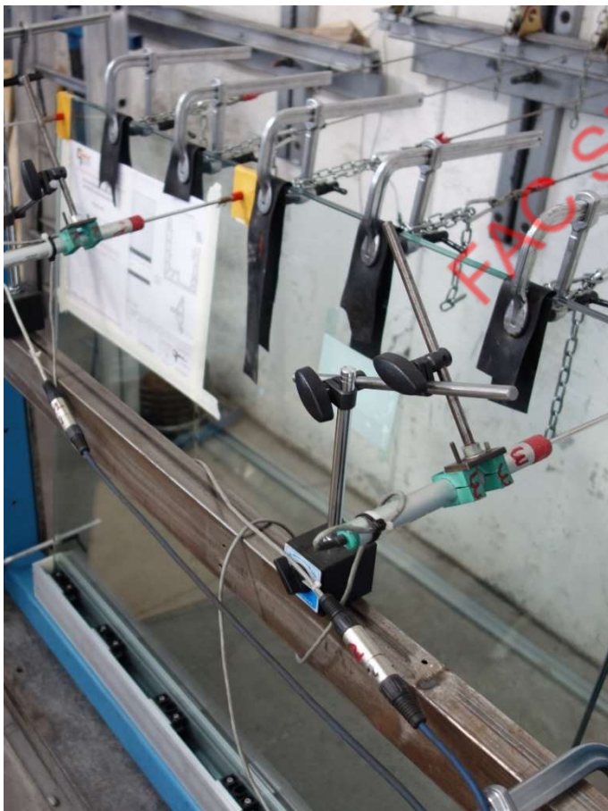
Fotografia dell'oggetto durante la prova di resistenza al carico statico orizzontale lineare
