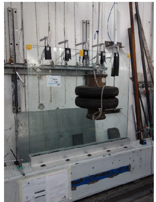
Fotografia dell'oggetto dopo l'impatto da corpo semirigido al centro del tamponamento
